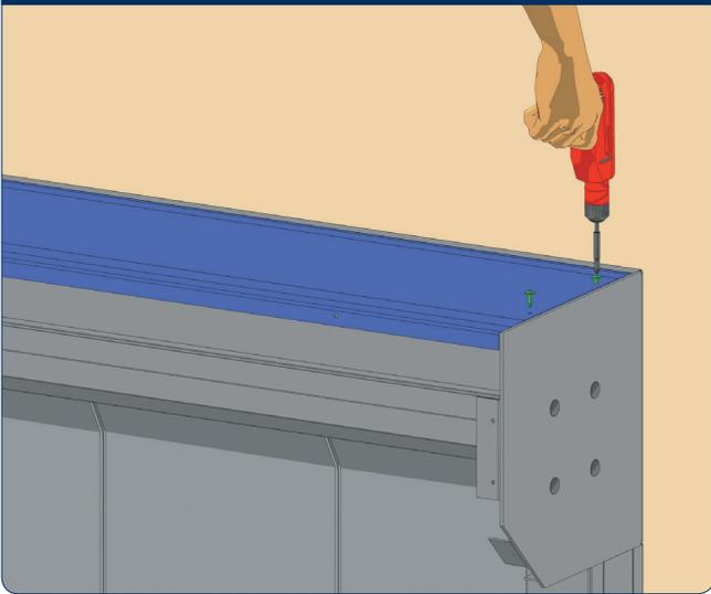
Закрепите крышку при помощи саморезов.
