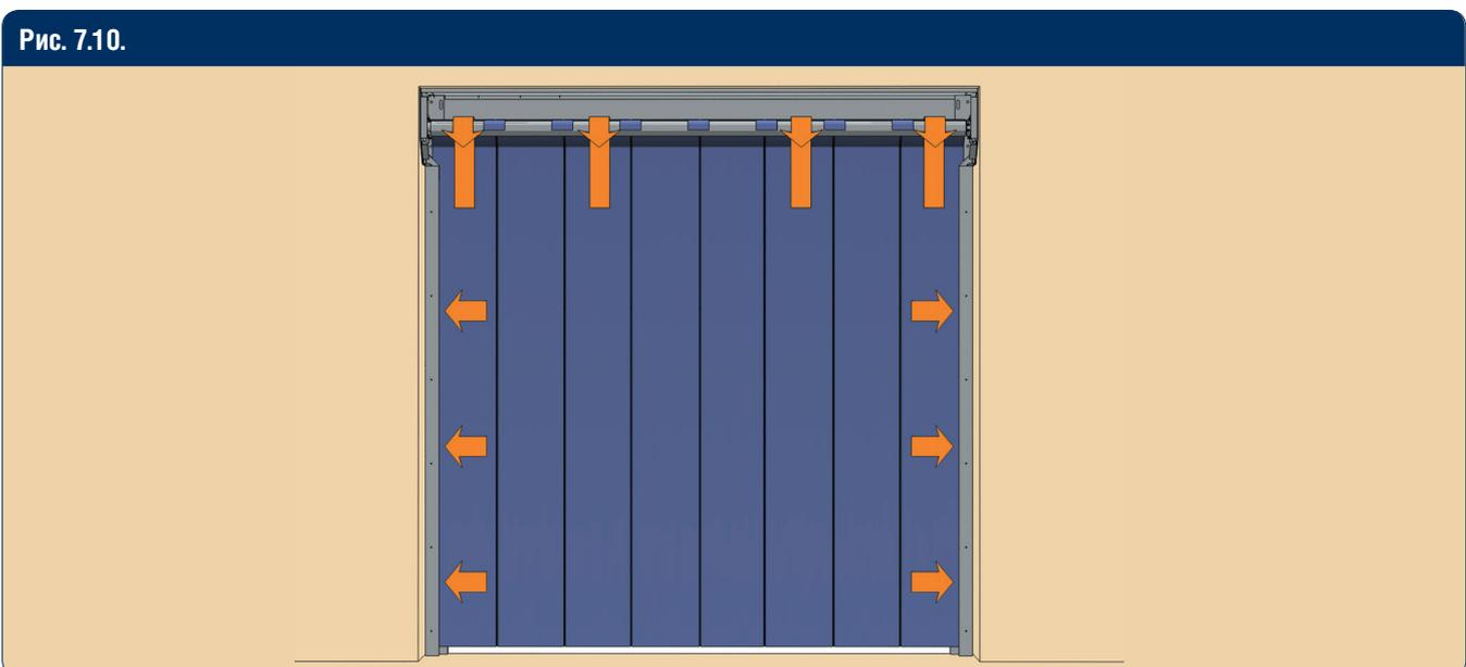
Установите и закрепите противоположную направляющую в проеме.
