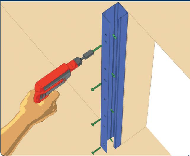
Закрепите по просверленным отверстиям направляющую саморезами или анкерными болтами в зависимости от материала проема. Для металла используются саморезы (рис. 6.9), для кирпича и бетона — анкерные болты (рис. 6.10).
