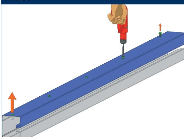
Направляющая состоит из двух частей. Необходимо разобрать направляющие: выкрутить болты и снять крышки.
