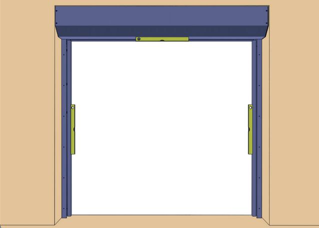
Каркас противопожарной шторы должен быть установлен строго вертикально (проверьте строительным уровнем).
