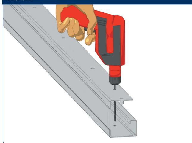
Просверлите отверстия в направляющих. Сначала просверлите отверстия сверлом под саморез или анкерный болт насквозь.
