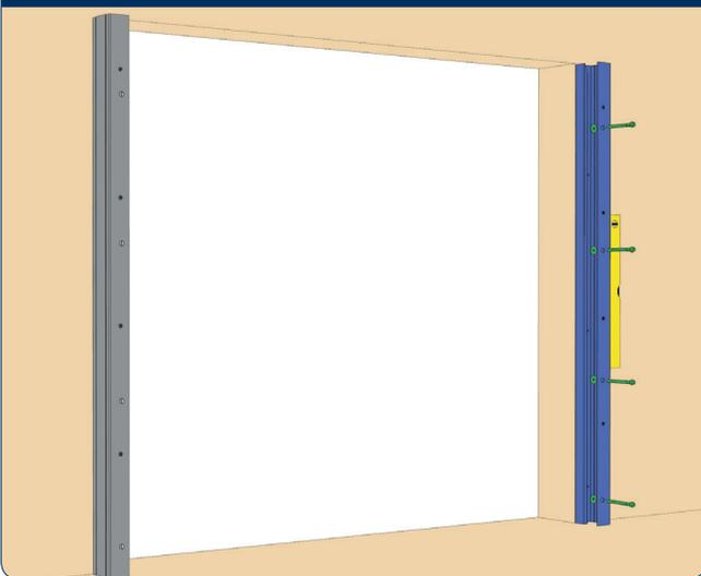
Установите и закрепите противоположную направляющую в проеме.
