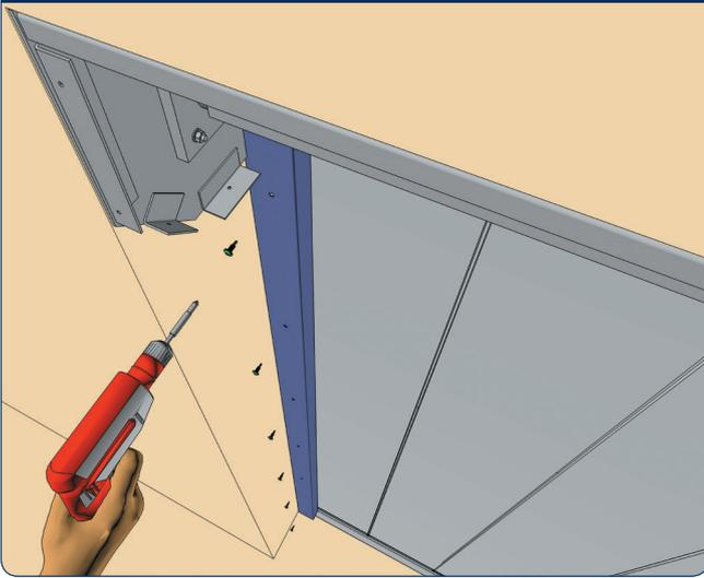
Закрепите крышки направляющих при помощи болтов.
