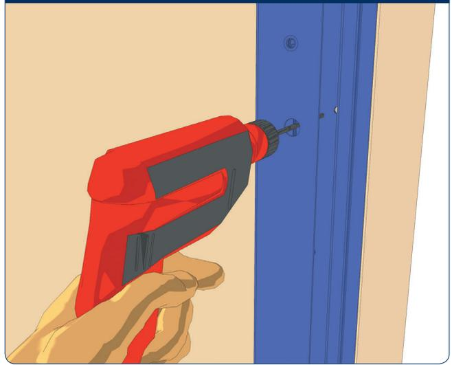
Просверлите отверстия в стене для самореза или анкерного болта.
