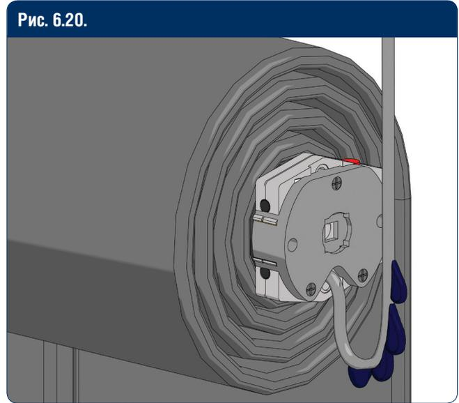
Для предотвращения попадания влаги, монтаж кабеля электродвигателя следует проводить с загибом (рис. 6.19, 6.20).
