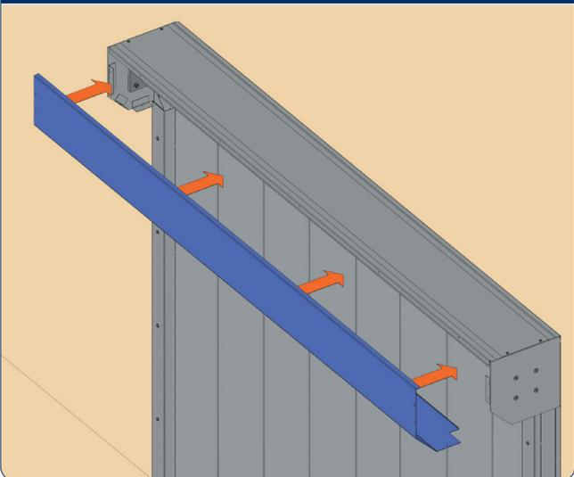
Закрепите переднюю крышку при помощи саморезов.
