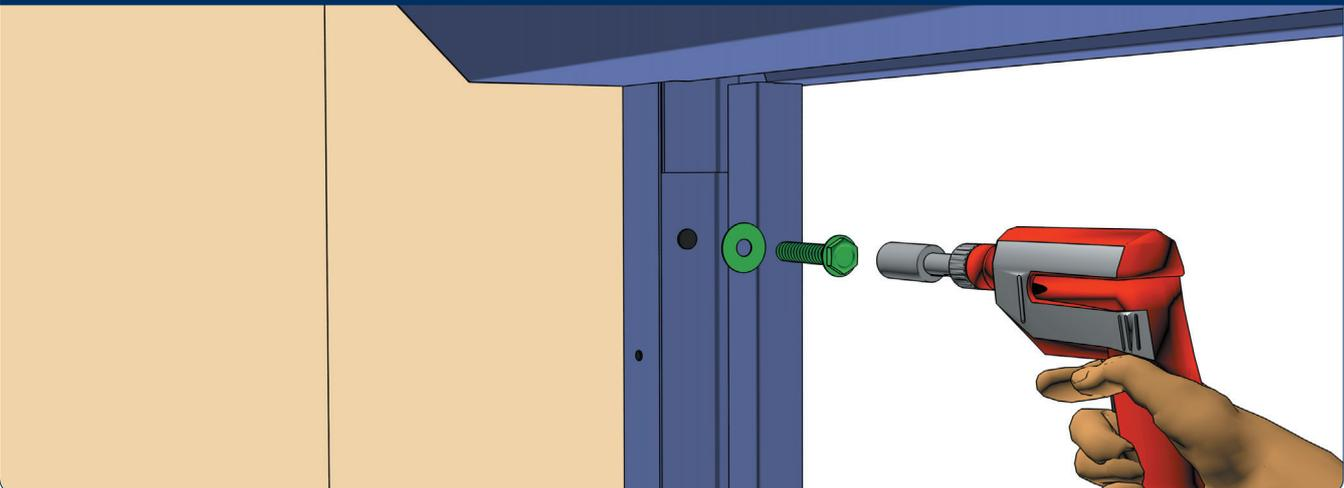
Закрепите по просверленным отверстиям направляющие при помощи саморезов (для стен из металла) или анкерных болтов (для стен из кирпича и бетона).
