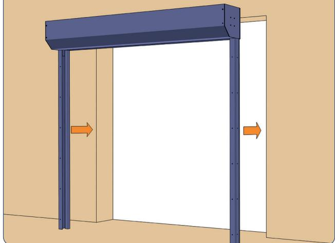
Вставьте каркас противопожарной шторы в проем.
