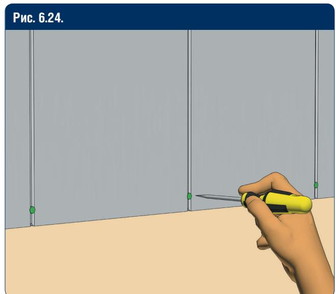
Проделайте отверстия в полотне для установки утяжелителя.
