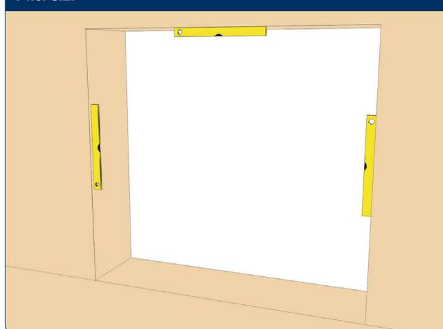
Проверьте качество подготовки обрамления проема. Материал проема должен обеспечивать устойчивость и жесткость конструкции шторы.
