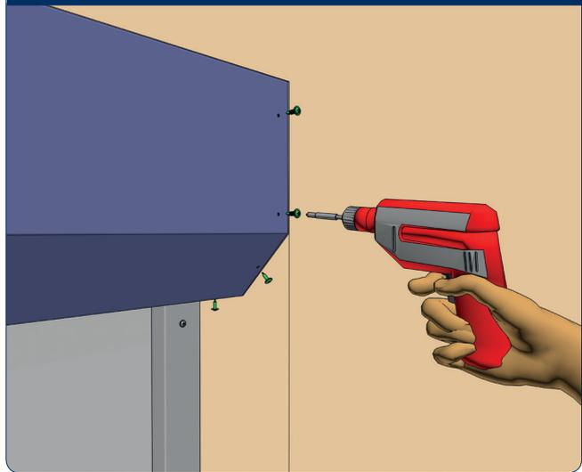
Закрепите переднюю крышку при помощи саморезов.
