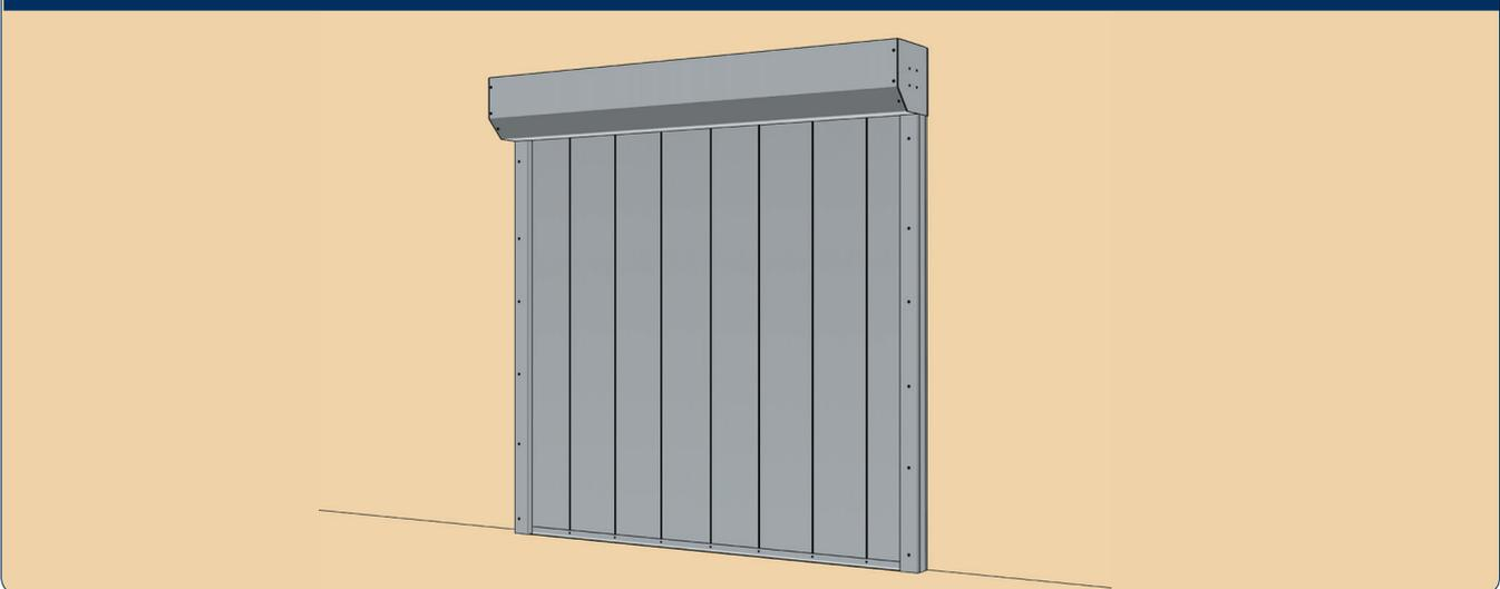
Проверьте правильность и надежность установки конструкции. Поднимите и опустите несколько раз полотно противопожарной шторы. Убедитесь в отсутствии посторонних звуков и в надежности крепления всех элементов.
