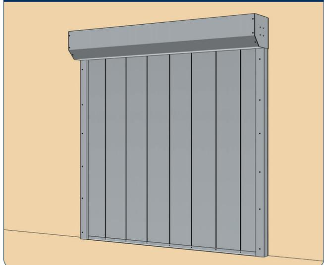
Проверьте правильность и надежность установки конструкции: поднимите и опустите несколько раз полотно противопожарной шторы.
