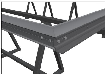
Соедините боковой (левый) основной несущий профиль с верхним несущим профилем с помощью саморезов по металлу (11).
