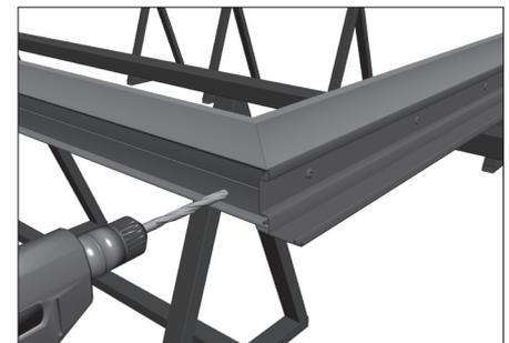
Просверлите намеченные отверстия сверлом  $\varnothing 4,2$  мм.
