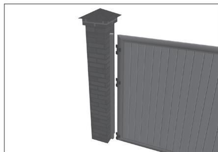
Поднесите створку к столбу. С помощью подкладок обеспечьте горизонтальность положения створки и необходимый просвет.
