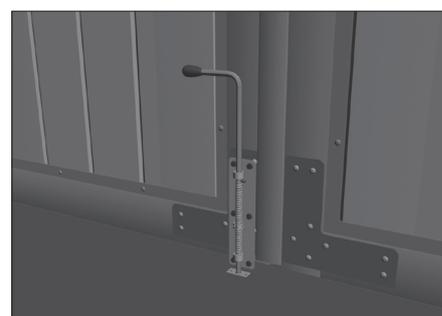
Закрепите задвижку с помощью 6 саморезов.
