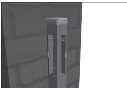
Строительным уровнем проверьте вертикальность расположения 2 перпендикулярных плоскостей каждого столба. Выставьте столбы относительно друг друга в одной плоскости с помощью уровней.
