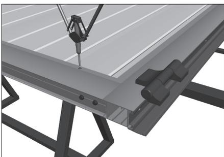
Скрепите панели с профилями для сборки панелей при помощи заклепок  $4,0 \times 12$ . Крепление осуществляется с внешней и внутренней стороны щита.
