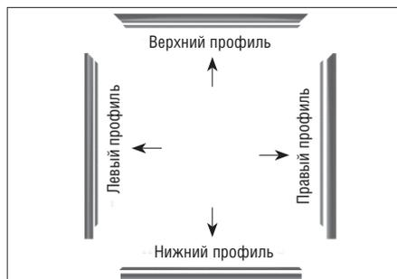
Возьмите основные несущие профили для сборки каркаса створки согласно приведенной схеме.
