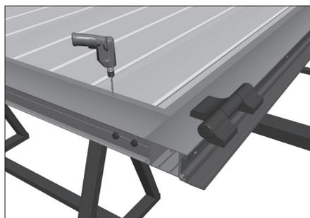
Просверлите отверстия в профиле для сборки панелей  $\varnothing 4$  мм с шагом не более 200 мм.
