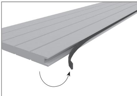
Перед окончательной сборкой створки удалите энергофлекс (уплотнитель) с нижних частей панелей.
