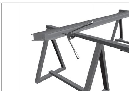
Закрепите профили (8) с помощью заклепок и клепателя. Повторите операцию по сборке профилей для всех профилей.
