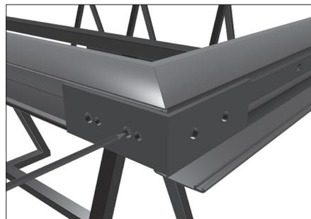
Через кондуктор (26) разметьте отверстия в верхнем и боковых несущих профилях для крепления их к угловому соединению щита.
