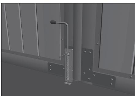
Разметьте отверстия для установки задвижки на одной из створок.
