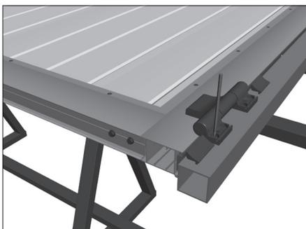
Сделайте отметки под крепление петель и просверлите отверстия  $\varnothing 8$  мм.
