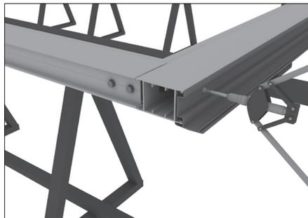
Закрепите профили при помощи заклепок.
