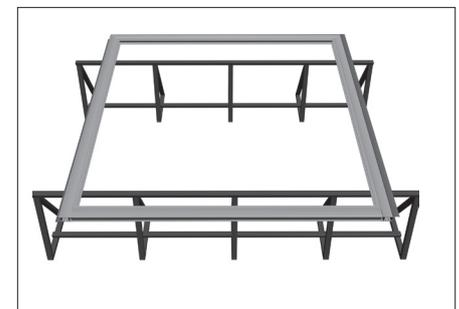
Предварительная сборка каркаса створки выполнена.
