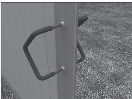
С помощью воротка попеременно закрутите оба винта по 3–5 мм за прием. Так как винты и ручки имеют правую и левую резьбу, то при вкручивании винта в первую ручку происходит одновременное вкручивание другого конца винта во вторую ручку.
